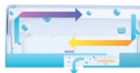
Ciklus strujanja zraka kod klasičnih hladnjaka - vlaga se gubi i namirnice isušuju
